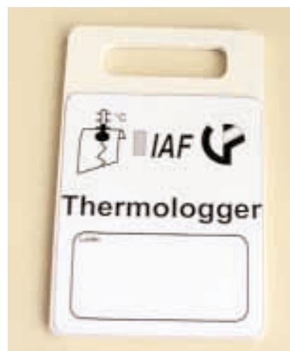
**Abb. IV-2.1:** Thermologger-Chipkarte zur Aufzeichnung von Temperaturprofilen mit ASIC der FH Offenburg
