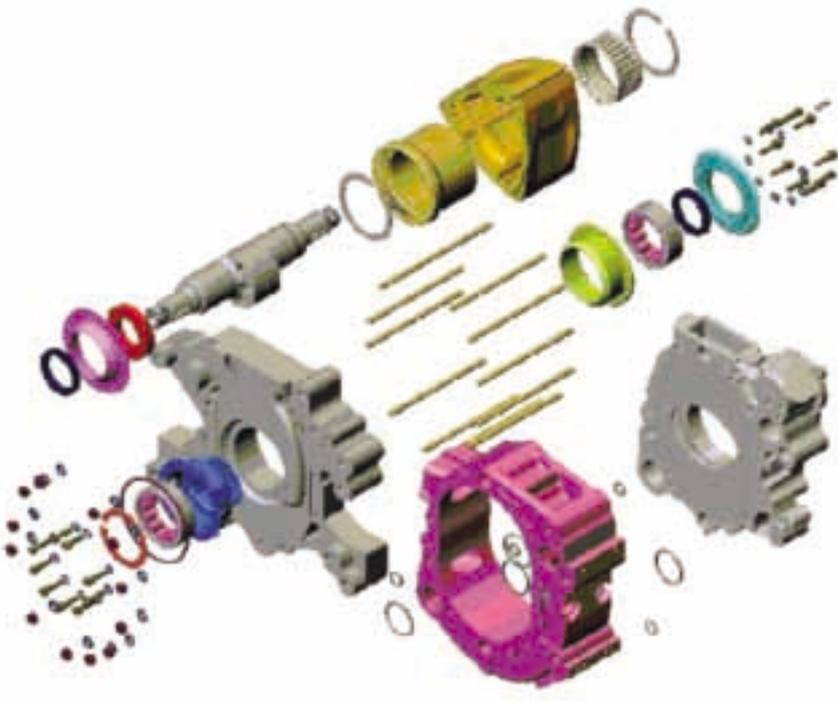
**Abb. IV-15.1:** Explosionszeichnung eines Wankelmotors
