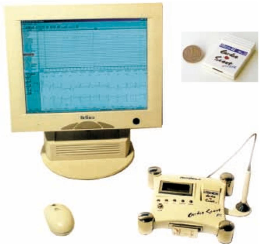
Abb. IV-3.2: Das System Cardio Scout, entwickelt auf der Basis von MINELOG, mit Recorder-Modul, Lesestation und Auswertprogramm auf PC
