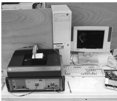
**Abb. IV-10.1:** Prototyp des an der FH Offenburg entwickelten Dünnschichtscanners
