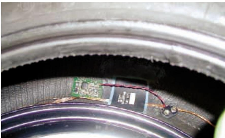
**Abb. IV-1.1:** CiR-Modul mit ASIC der FH Offenburg und Antennenspule in Kfz-Reifen integriert (Experiment)
