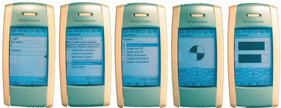
**Abb. IV.21-3:** mLab-Screenshots: Login-Screen, Multiple-Choice-Test, Simulationsläufe mit Status, Netzwerk-Verbindungs-Warteanzeige und Simulationsfortschritt-Anzeige.
