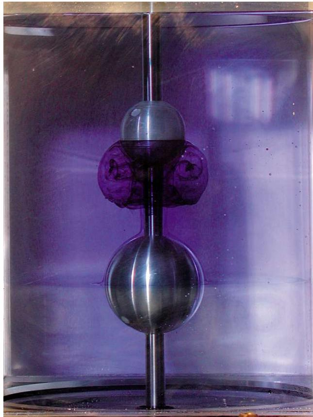
*Abb. IV.12-3: Sekundärströmung in der Umgebung rotierender Kugeln*
