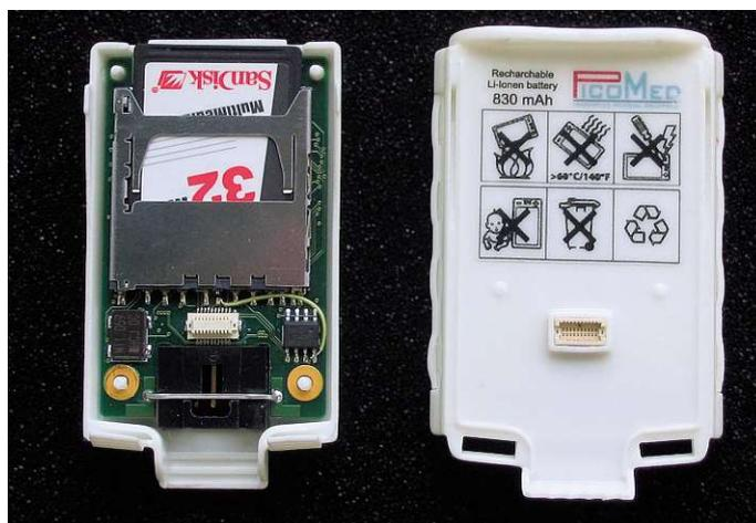
Abb. IV.3-3: Geöffneter Recorder (links Elektronik mit SD-Kasten-Einschub, rechts Akku-Modul)
