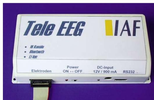
Abb. IV.1-2: Tele-EEG – System mit Bluetooth-Telemetrieschnittstelle
