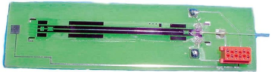
Abb. IV.4-1: Optischer Messmultiplexer mit Lichtwellenleiter, entwickelt in Ristton-Technik vom IMTEK, Freiburg
