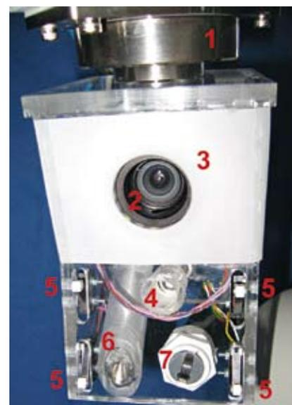
Abb. 1.4-2: Messkopf am Ende des Roboterarms
