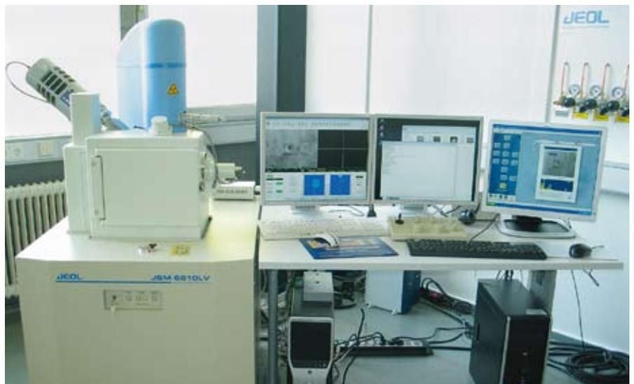
**Abb. 3.3-1:** Gesamtansicht des Raster-Elektronenmikroskops mit EDX-System
