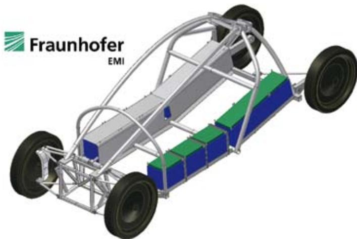
Abb. 1.6-2: Rahmenstruktur des „Schluckspechts E“ – „Bow String Structure“
