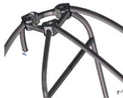
Abb. 1.6-3: Randbedingungen für die statische Belastungssimulation nach FIA-Reglement
