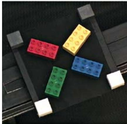
**Abb. 1.5-4:** Bestimmung der Lage von DUPLO-Steinen über ein Bildverarbeitungssystem (Quarti 2010)
