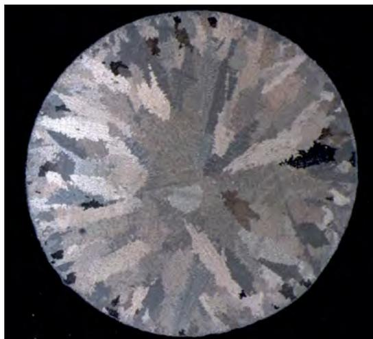
**Abb. 1:** Lichtmikroskopische Aufnahme der Mikrostruktur einer Legierung, die in Flugturbinen eingesetzt wird. Es sind Körner und Korngrenzen sichtbar
