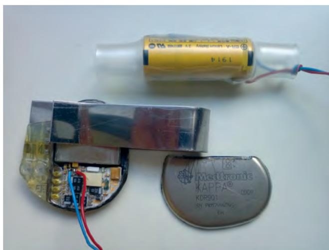
**Abb. 3:** Geöffneter Herzschrittmacher Kappa KDR 901 nach dem Anschließen der externen Batterie. Rotes Kabel – positiver Pol, blaues Kabel – negativer Pol
