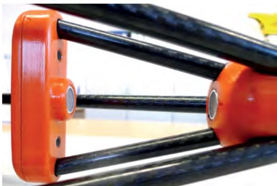
**Abb. 2:** Funktion der Lufttemperatur und Luftströmungsmessung
