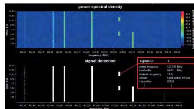
**Abb. 2:** Messdaten der Monitoring-Station (oberes Bild) und Ergebnis der Signalanalyse für die Frequenzüberwachung
