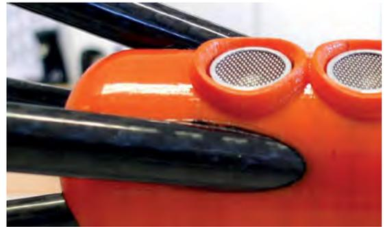
**Abb. 4:** Im Prototyp integrierter Messkopf zur Messung der Rohrdimension
