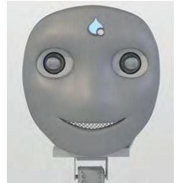
Das Gesicht wurde mit dem 3D-Drucker Ultimaker 3 der Hochschule Offenburg gedruckt. Als Grundmaterial wurde PLA (Polylactic Acid) verwendet, die notwendigen Stützstrukturen wurden aus einem wasserlöslichen Polyvinylalkohol gedruckt.
