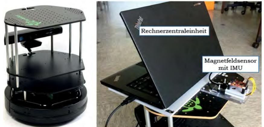
Abb. 4: Mobile Roboterplattform (links) und Versuchsaufbau mit Magnetfeldsensor-IMU-Kombination (rechts)
