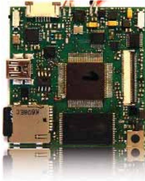
*Bild 2: Multilayer-Platine des PDA mit SIRIUS-JANUS als UMC-ASIC,  $\mu$ SD-Card, USB-Interface, Touch Interface, OLED-Interface und RFID-Reader, 2010*
