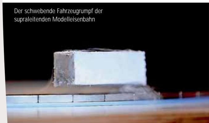
Der schwebende Fahrzeugrumpf der supraleitenden Modelleisenbahn
