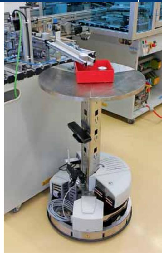
Abbildung 2: Robotino für Transporte in der Werkzeugmaschinenhalle
