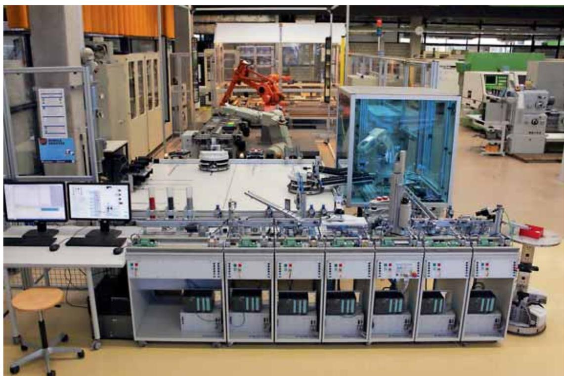
Abbildung 1: Gesamte ProLog-Anlage. Im Hintergrund sind weitere Roboter- und Transportsysteme zu sehen, die auf die Ausgaberrampen zugreifen könnten
