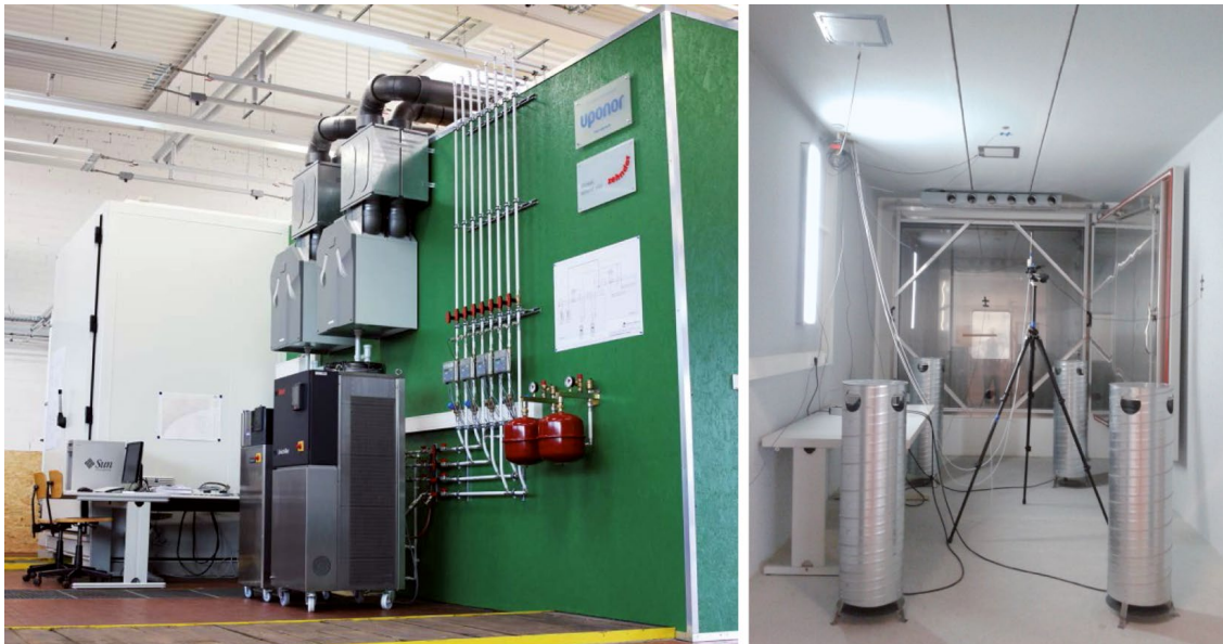
Bild 1. Links: Raumklimalabor mit begehbare Klimakammer (im Hintergrund, weiß) und zwei baugleichen Prüfkammern (grün). An der grünen Wand sind gut Lüftungstechnik sowie Heiz- und Kühlsysteme mit zwei Thermostaten zu erkennen. Rechts: Blick in eine Prüfkammer mit Fassade zur Klimakammer, Kühllastsimulatoren und Messtechnik (Quelle: Hochschule Offenburg)
