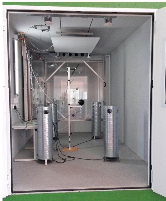
Bild 1. Versuchsaufbau: Blick in eine der beiden Testkammern mit mobiler und fest installierter Messtechnik. Sowohl das Heiz- und Kühlsegel als auch die Kühllastsimulatoren sind gut zu erkennen. Die Zuluftöffnungen liegen fassaden-nah hinter dem Heiz- und Kühlsegel. Der Raum ist thermisch über die Glasfassade und lüftungstechnisch über die Lüftungsanlage mit der (Außen-) Klimakammer verbunden Fig. 1. Experimental setup: View into one of the two test chambers with mobile and fixed monitoring equipment. Both the heating and cooling sails as well as the cooling load simulators are clearly visible. The supply air inlets are located near the front of the heating and cooling sails. The room is thermally connected to the (outside) climatic chamber via the glass facade and via the ventilation system
