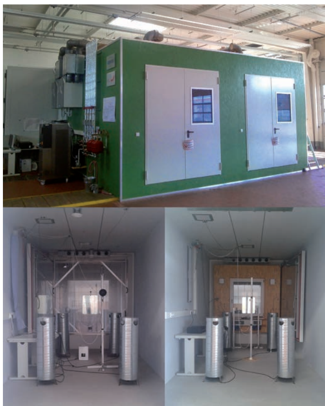
Bild 1. Raumklimalabor mit begehbaren Klimakammer und zwei baugleichen Testkammern (hier mit unterschiedlichen Fassadensystemen und Kühllastsimulatoren nach DIN EN 14240)
