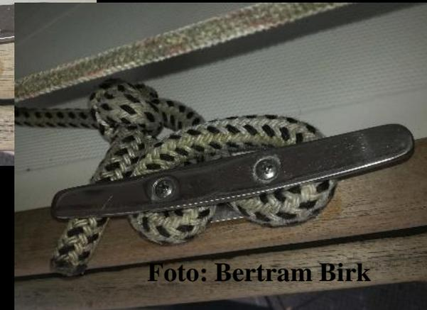
Wenn es bei Seitenwind schnell gehen muss, Palstek einfach mal über die Klampe legen. Wenn das Boot sicher liegt, Palstek wie gezeigt durch die Klampe führe usw.
