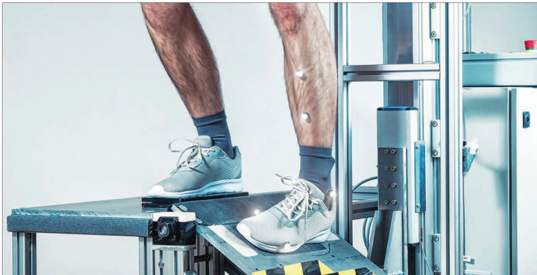
Auf einer Umknickplattform werden Daten erhoben, um die adaptive Sporttechnologie weiter zu erforschen. Die rein mechanische Methode soll das Sprunggelenk vorm Umknicken schützen, indem sie in Millisekunden die zu schnelle Bewegung erkennt und versteift. Foto: Betterguards
