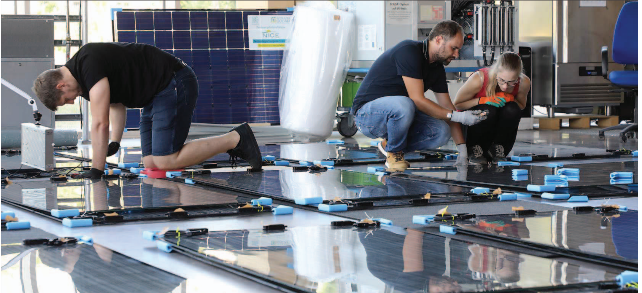
Bevor die Projekt-Teilnehmer die Balkonsolarmodule aus Frankreich zu Hause installieren konnten, wurden im Regionalen Innovationszentrum für Energietechnik (RIZ Energie) etwa noch die Kupferkabel verlötet und die Anschlussboxen mit Silikon angeklebt. Foto: Christoph Breithaupt
