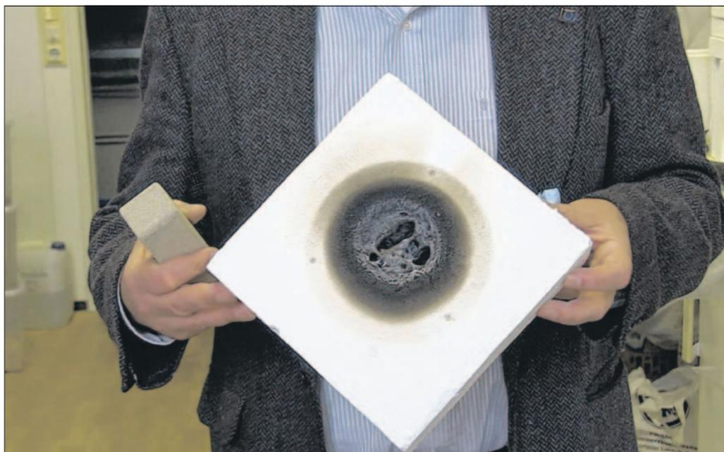
Der Dämmstoff aus Wasserglas ist feuerfest: Nach zwei Stunden überm Bunsenbrenner schmornte nur ein überschaubares Loch hinein.
